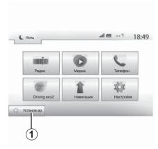
С помощью этой функции (если она предусмотрена в данной комплектации автомобиля) можно запрограммировать время дистанционного запуска двигателя для прогрева или вентиляции салона в период до 24 часов перед предполагаемым использованием автомобиля.
